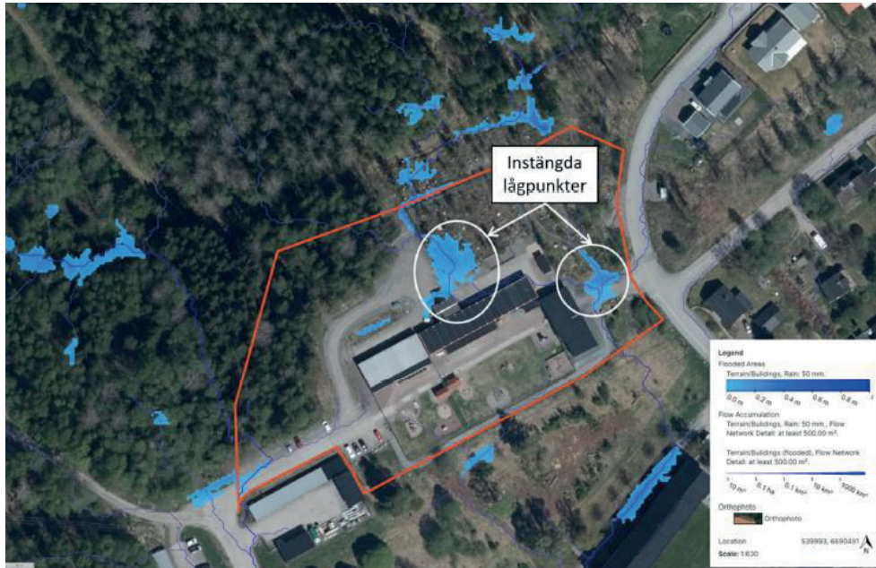
Lågpunkter och rinnstråk inom planområdet vid 50 mm regn och negligerad infiltration (Norconsult Sverige AB)
