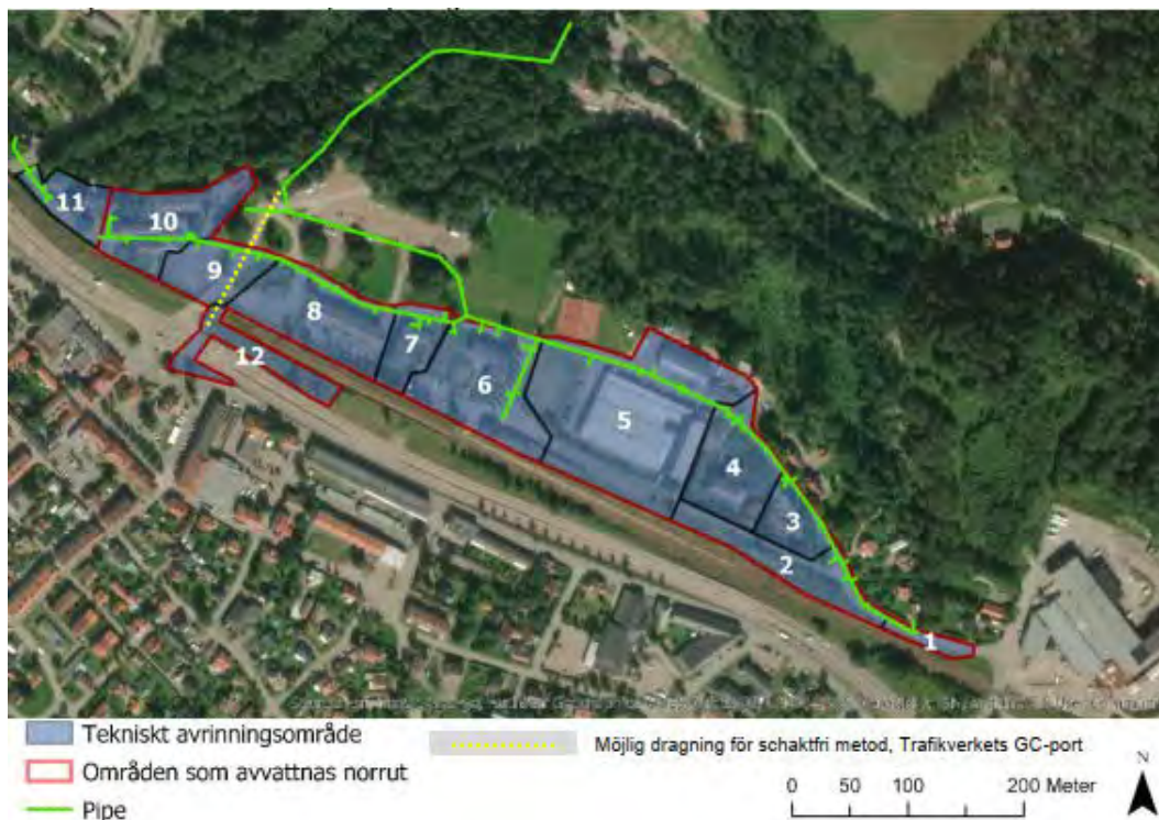
Figur 2. Förslag på nytt dagvattensystem (Tyréns, 2020).
