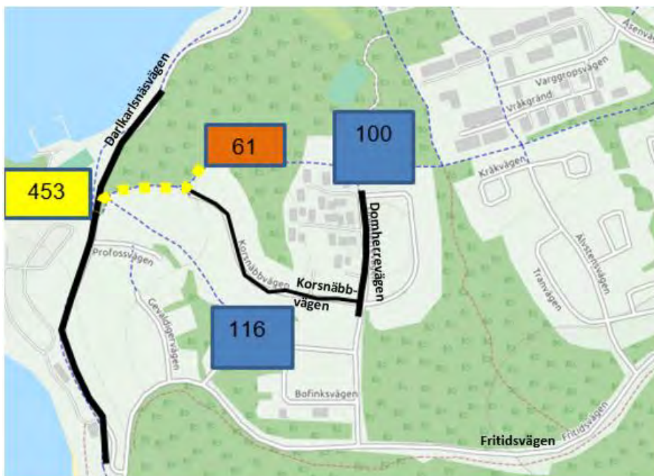
Figur 5. Uppskattade trafikflöden (ÅDT) år 2040 vid en utbyggnad av planområdet och med anslutningsväg enligt alternativ 1. Orange ruta visar ungefärligt planområdet Präst Källa och dess alstring av biltrafik.
