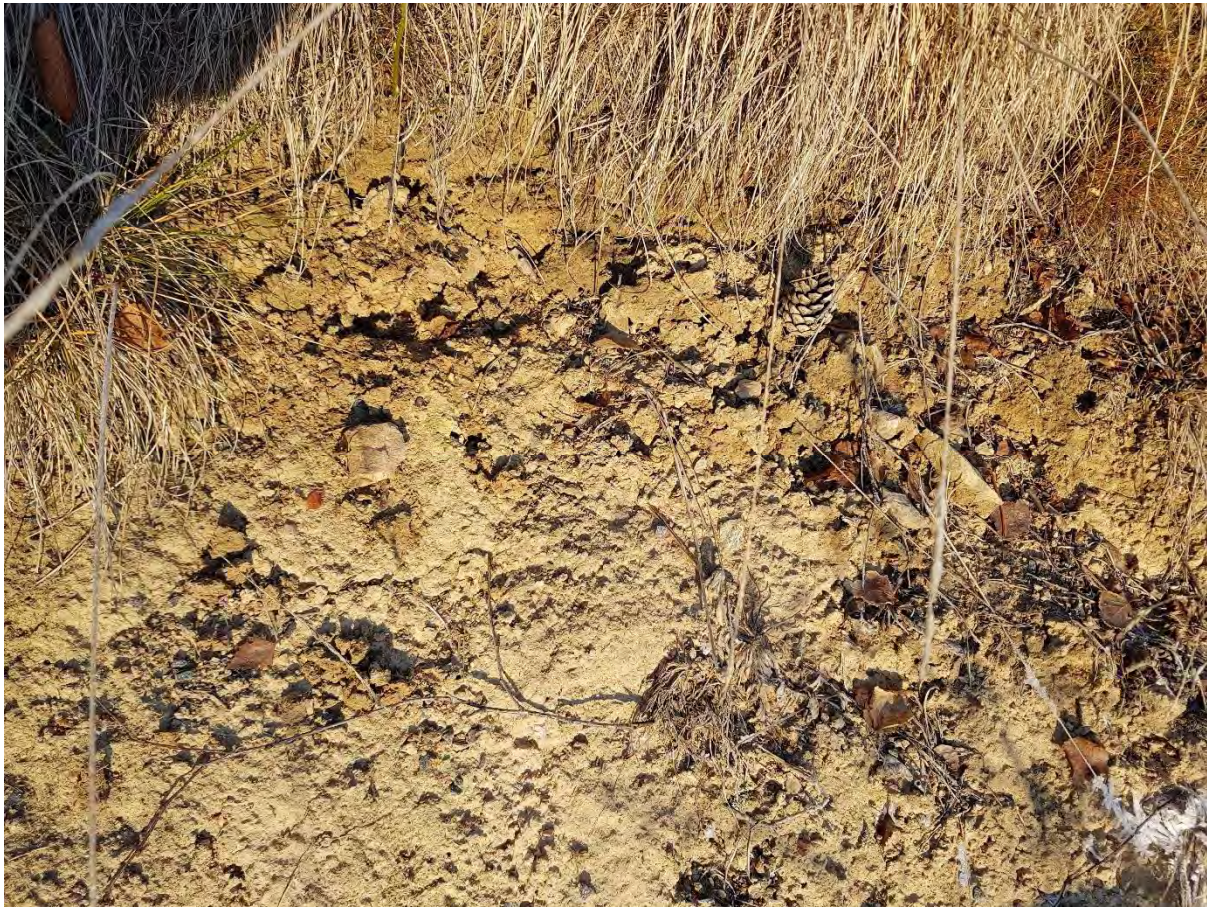
Figur 5. Siltig sandig morän (sisaMn) i vägskärning vid GC-vägen söder om området.
