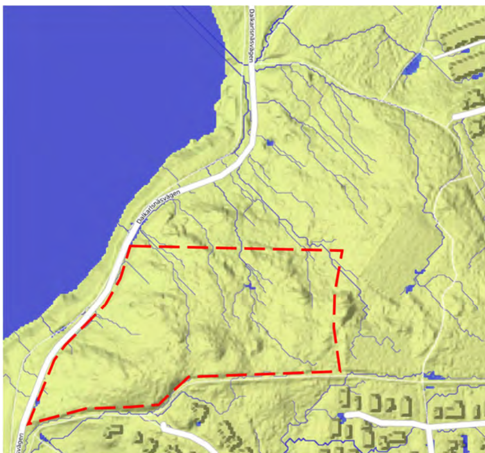
Figur 5. Befintlig avvattning av området, sker mot nordväst. Ungefärligt utredningsområde har markerats med röd streckad linje, Källa: SCALGO Live ( www.scalgo.com ).
