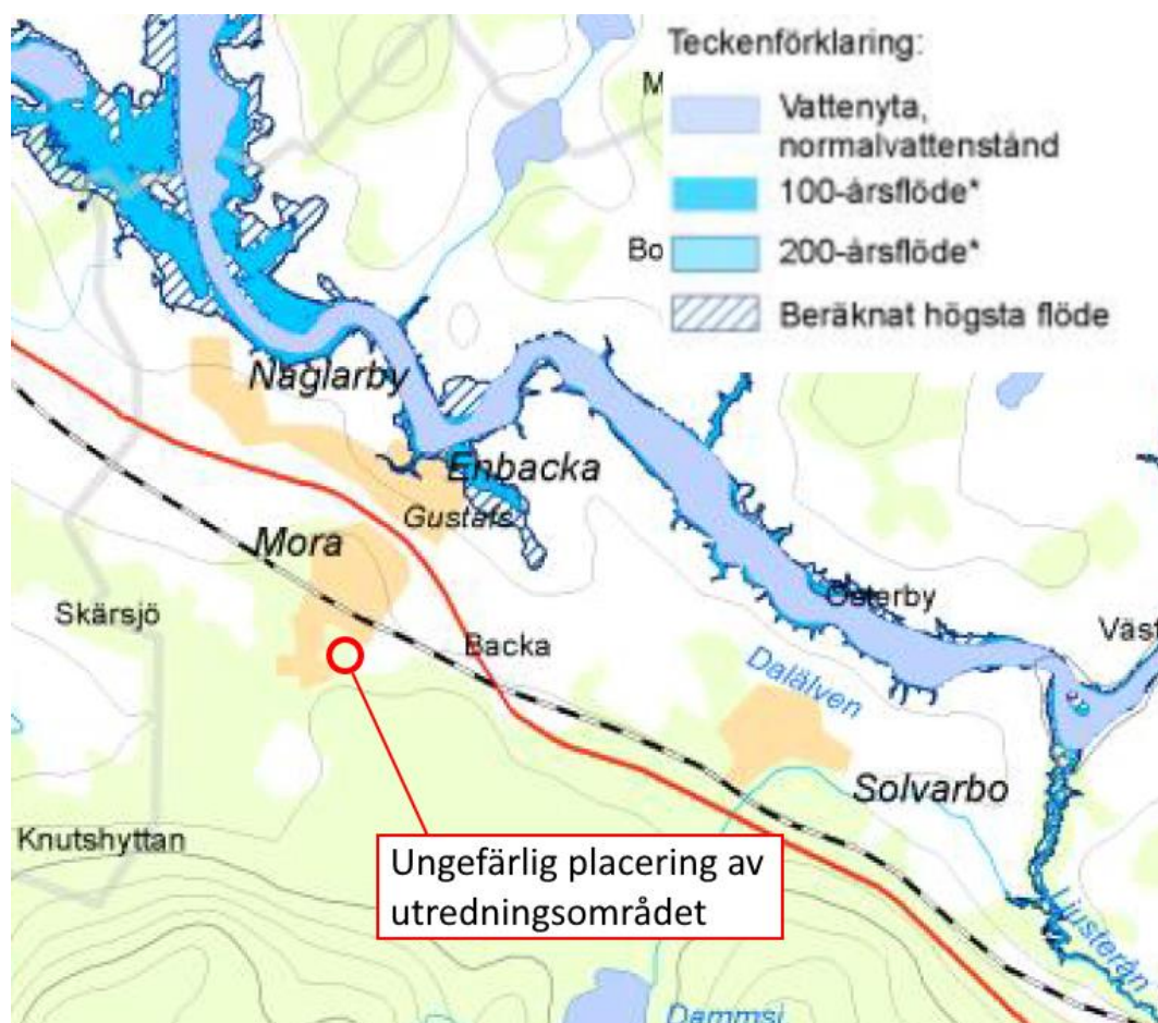
Figur 12. Översvämningsutbredning vid höga flöden i Dalälven. Utbredningen är hämtad från Översvämningsportalen (MSB, 2015). Den röda cirkeln indikerar hur högt vattnet närmast utredningsområdet kommer stiga och det noteras att det inte passerar varken väg 70 eller järnvägen. Bakgrund: Ortofoto från Lantmäteriets visningstjänst.
